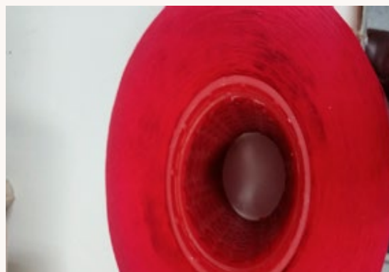
Foto 7: Manchas por retención de colorante aglomerado.
