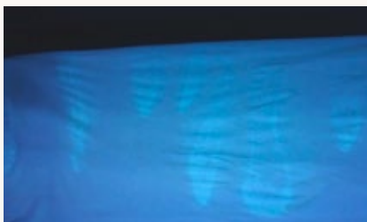
Foto # 12: Defecto en termofijado
