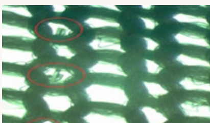
Foto # 13: Tejido de poliéster con daño en el elastano.
