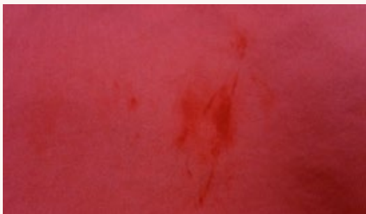
Foto 3: Manchas en tela por efecto de antiespumante.
