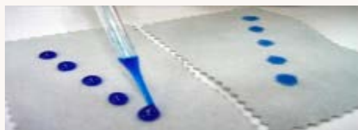
Figura 5. Mejora de la mojabilidad en un tejido flocado de PA6,6 (a la derecha, tratado 1 min con plasma de O 2 ).
