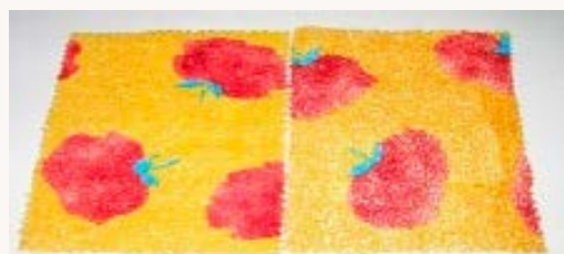
Figura 6. Mejora de la estabilidad en la estampación de un tejido de rizo de PES (a la izquierda, tratado 1 min con plasma de O 2 ).
