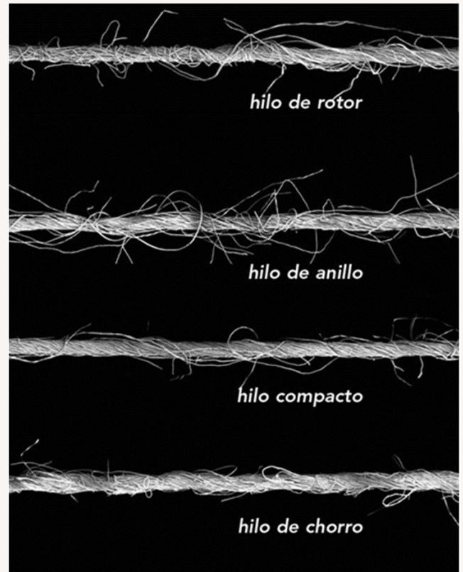
Figura 4. Sistema de hilatura. Fuente: RIETER.
