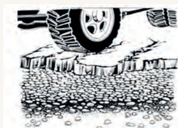
Figura 8: Ilustración sin geotextil
