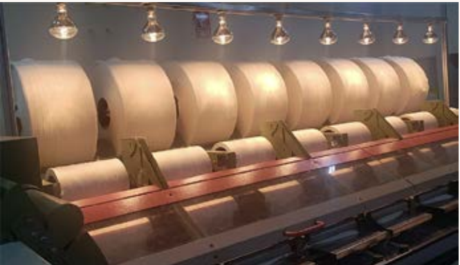
(Fig.12) Otra forma de generar una temperatura de 32 °C a 35 °C en la sala de peinadoras, para derretir la melaza, es mediante el calor generado por focos LED amarillos instalados a cierta altura para lograr una mayor efectividad. Con esta medida se consigue recuperar la eficiencia habitual.
