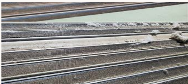
(Fig.4) Chapones móviles con alto grado de melaza. Obsérvese las fibras completamente compactadas en la superficie interna y en profundidad del chapón móvil. Su limpieza y extracción toman varias horas e incluso turnos completos para poder deschaponar, además del daño a las púas y del desgaste prematuro que esto ocasiona. Está demás decir que los Nep/g se desbordan por encima de los límites de control, teniendo que disminuir la velocidad, con la consecuente pérdida de producción.
