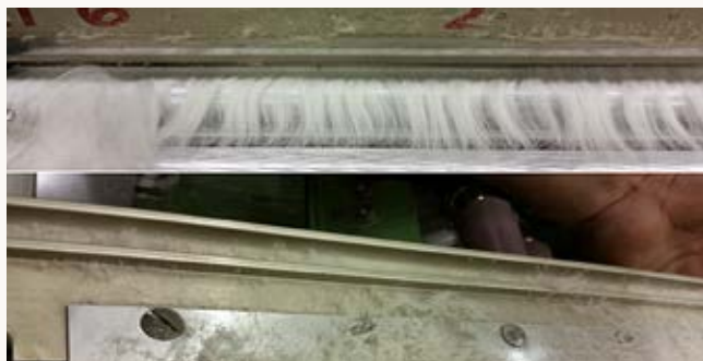
(Fig.7) Melaza o azúcar retenida e impregnada en los peines fijos y cilindros de la peinadora.
