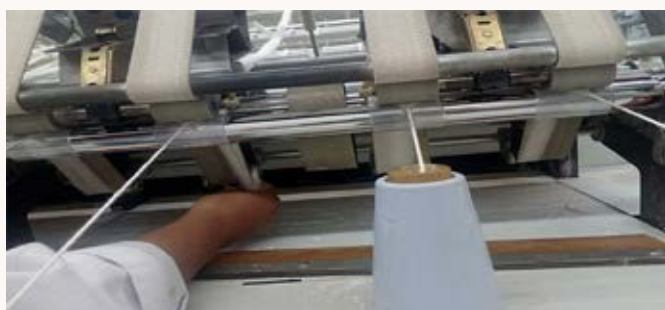
(Fig.8) Impregnación de melaza o azúcar en las bandas inferiores de las mecheras. Otro caso de alto riesgo, al no existir paro. El estiraje de la cinta, al transformarse en mecha sobre la capa de fibras acumuladas por la melaza, ocasiona una mecha irregular. La figura ilustra la limpieza manual debajo de la banda, la cual contiene fibras adheridas en su periferia. Todo un caso invisible.
