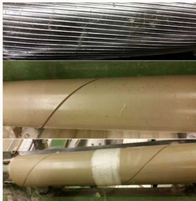
(Fig.5) Cilindros (imagen superior) y rodillos de todos los procesos impregnados de melaza, incrustada en las estrías o ranuras de los cilindros, lo que dificulta su limpieza. Aun cuando la melaza se logra remover, al cabo de pocos minutos vuelve a impregnarse debido a que está presente de forma permanente en el algodón. Es cuestión de pocos minutos para que se produzca nuevamente el enredo y el posterior paro de la máquina, con el consiguiente perjuicio para la producción.
