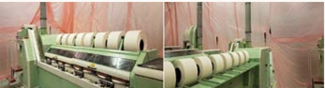
(Fig.11) Sala de peinadoras hermetizada para lograr una mayor temperatura en la sala. Una medida poco ortodoxa, pero efectiva.
