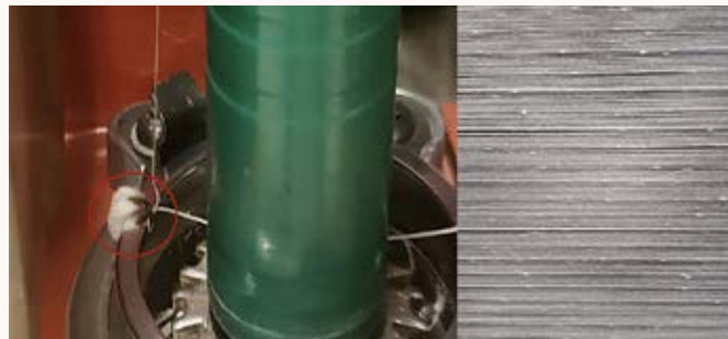
(Fig.10) Los cursores o viajeros de las continuas de hilar no escapan a la contaminación por melaza o azúcar. Al impregnarse entre el arco del cursor, se forman “donas” o acumulaciones de fibras, las cuales se trasladan al hilo luego de generarse en un ciclo constante de formación de “Naps” (incremento de masa superior al 200 %). Esto provoca en la contera cortes sucesivos que pueden alcanzar valores de 2,000 o 3,000 por cada 1,000 km, toda una tragedia, dependiendo del grado de Honeydew o melaza.
