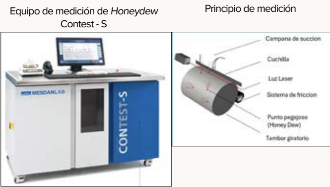
(Fig. 13) A la izquierda, el equipo de medición CONTEST-S y a la derecha, el principio de medición que utiliza. Material para analizar: 3.5 g, tiempo de prueba: 30 segundos/muestra.
