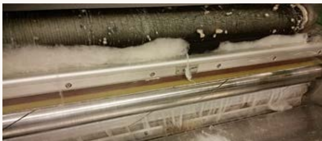
(Fig.3) Obsérvese enredos en la carda. El velo no logra asirse a la calandra, cuelga y no transcurre por el par de cilindros. La limpieza frecuente con alcohol, solvente o yodo no logra diluir la melaza o azúcar. Los paros y arranques son frecuentes. La producción de cinta de cardas y los cumplimientos se ven afectados drásticamente.
