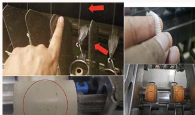
(Fig.9) Los problemas ocasionados por la melaza o el azúcar no dejan de ser importantes en las continuas de hilar; por el contrario, es en esta etapa donde la impregnación se solidifica aún más, al ser la última fase de transformación. Los revientes o roturas de hilo, así como la irregularidad provocada por la acumulación de melaza en los canales de los cilindros, conllevan a que los indicadores de producción y calidad se sitúen por debajo de los objetivos, con el consiguiente rechazo o incumplimiento de lo planificado. Es un problema invisible para el programador, pero evidente en la planta debido a la baja producción alcanzada por el tiempo dedicado a desenredar.
